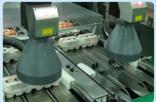
安装在蛋箱生产线上的激光打码机
